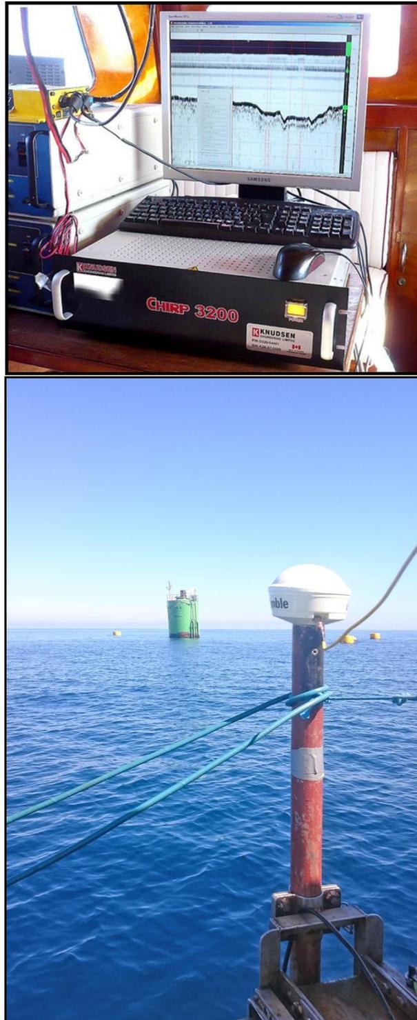
**Figura 4.** Perfilador sísmico Chirp Knudsen 3200 en operación (arriba) y soporte del transductor durante la toma de datos (abajo).
