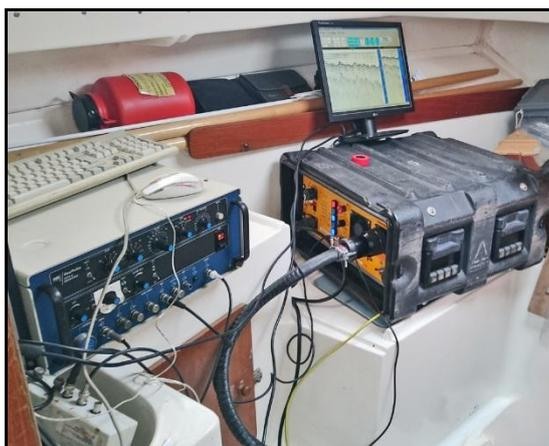
**Figura 8.** Unidad de control y banco energético del equipo Boomer montado a bordo de la embarcación
