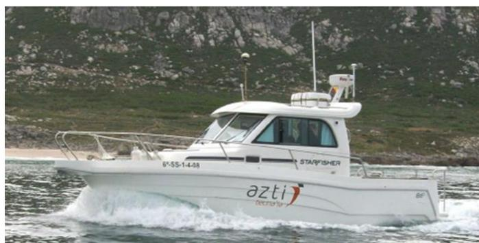
**Figura 2.** Embarcación AZTIMAR BAT empleada para las tareas de levantamiento batimétrico de alta resolución con sonda multihaz.
